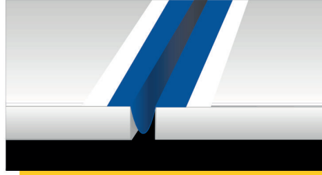
Birleşim noktasında Mapeband Ω pozisyonu.
