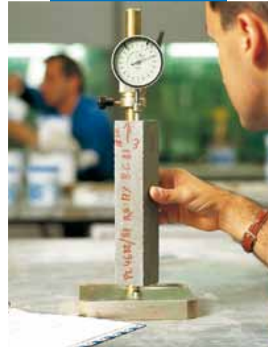
UNI 8147'ye göre kontrollü genleşmenin tespiti
