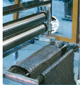
MapeWrap C kumaşın makina ile empenye edilmesi
