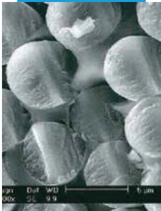
Mapei AR&GE laboratuvarlarından alınmış; polimerik matris yapısal kompozitin mikroskopik fotoğrafı
