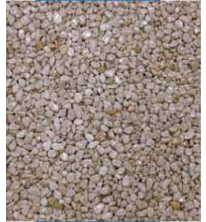
Doğal agregalar + Mapefloor I 910 uygulaması
